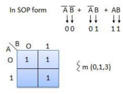
Answer:  $\overline{A} \overline{B} + \overline{A} B + AB = \overline{A} + B$
